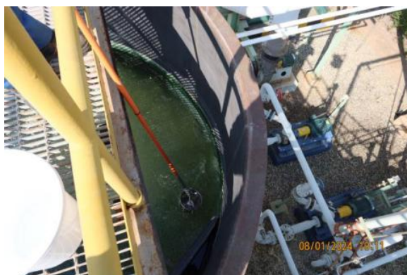
ภาพถ่ายที่ 2.2.2-8 ระบบบำบัดน้ำเสียระบบ Extended Activated Sludge System
